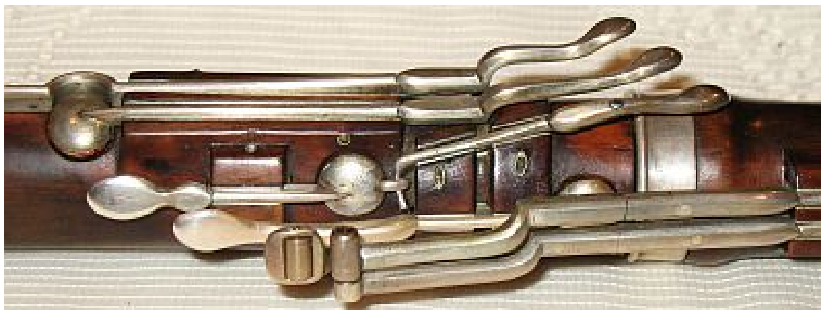
Mechanikai megoldása egy G-lábas Ziegler fuvolán a bal kéz hüvelykujj és a jobb kéz mutatóujj számára.
