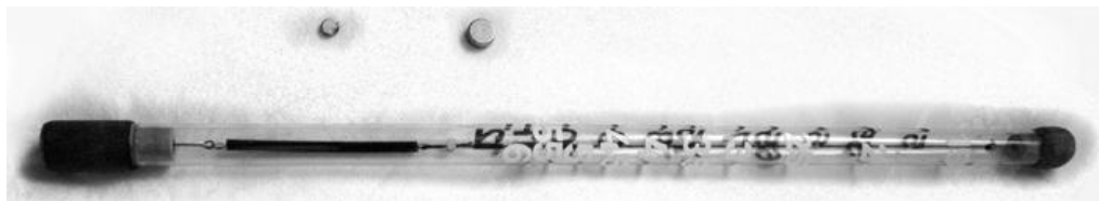
55. ábra Mágneses vastagságmérő. A kép felső részében különböző méretű mágnesek láthatók. A kis mágnes a vastagságmérő fehér számaihoz tartozik, 1,5-6 mm tartományban mér. A nagy mágnes a mérő másik oldalán lévő kék számokhoz tartozik, és 5-12 mm-ig mér.
