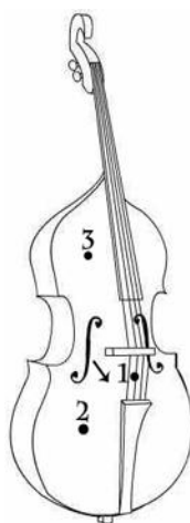
18. ábra A gyorsulásmérő elhelyezése (1. 2, 3) a test rezgések méréséhez. A megütés helyét a nyíl jelzi.
